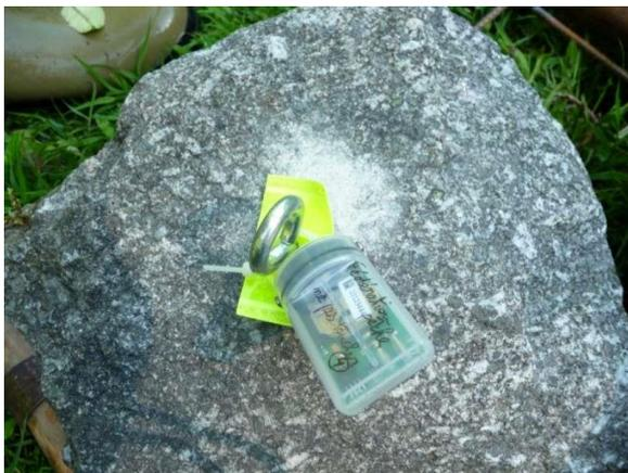
Figure 16 : dispositif de fixation d'une sonde
